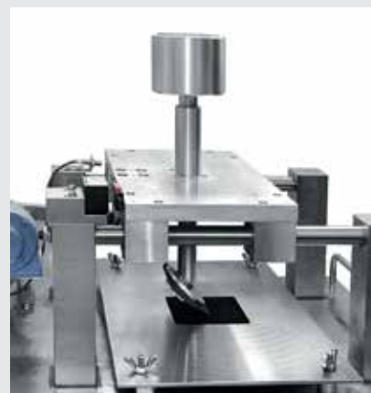
Heel test device
